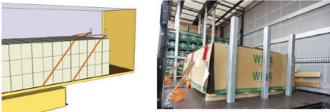
Figura 7: montanti utilizzati per il bloccaggio in avanti
