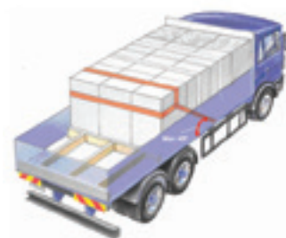
Figura 40: ancoraggio antirimbalzo tramite imbracatura
