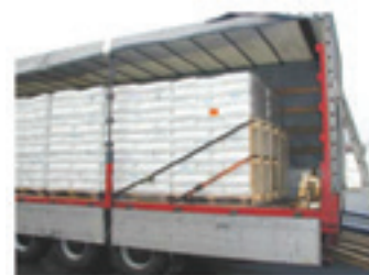
Figura 39: ancoraggio antirimbalzo tramite pallet
