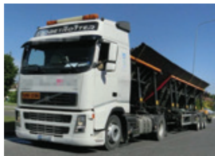
Figura 14: lastre di acciaio trasportate con un'inclinazione di 45°
