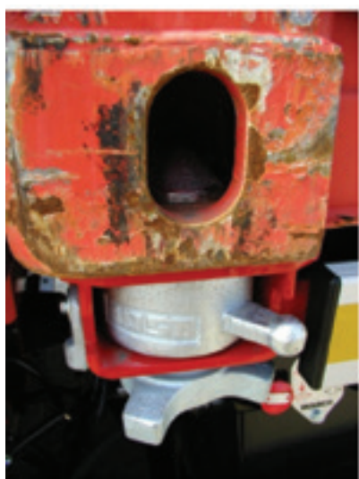
Figura 17: twistlock con container
