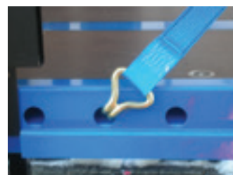
Figura 13: foro di ancoraggio nel profilo laterale
