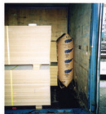
Figura 29: cuscino ad aria per bloccaggio laterale
